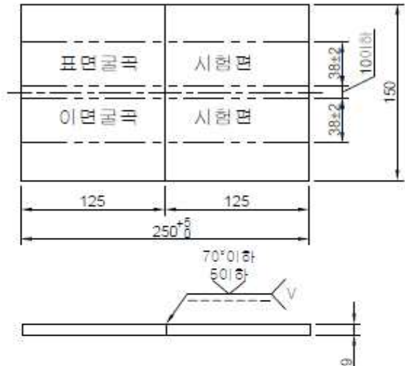
나) 플럭스코어드와이어 맞대기 용접
